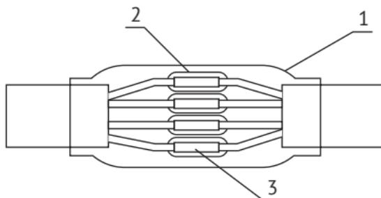
1 – внешняя трубка с внутренним слоем термоплавкого клея, защищает от механических воздействий, а благодаря склеиванию с внешней оболочкой кабеля обеспечивает герметизацию.
